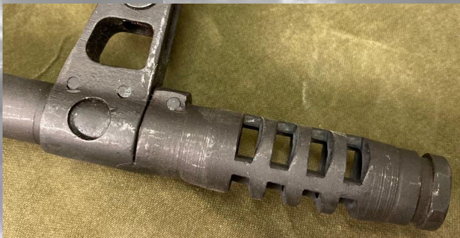
Cugir SSG-97 Mündungsbremse quer geschlitzt ohne Bajonettaufnahme.
