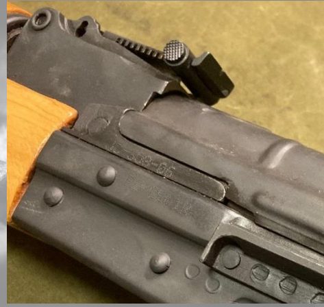
Verstärkungsrippen Höhe Hülsenauswurffenster.
