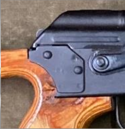
Stahlblechverstärkungen beim Kolben.
