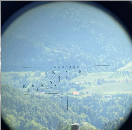
Absehen POSP (PSO-Clon) Zielfernrohr welches im Paket des Cugier SSG-97 mit dabei war.
