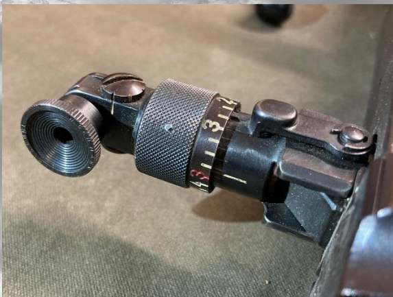
Diopter mit verstellbarer Blende
