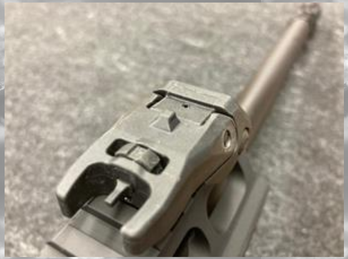
IMI Front-Sight eingeklappt mit Notvisier
