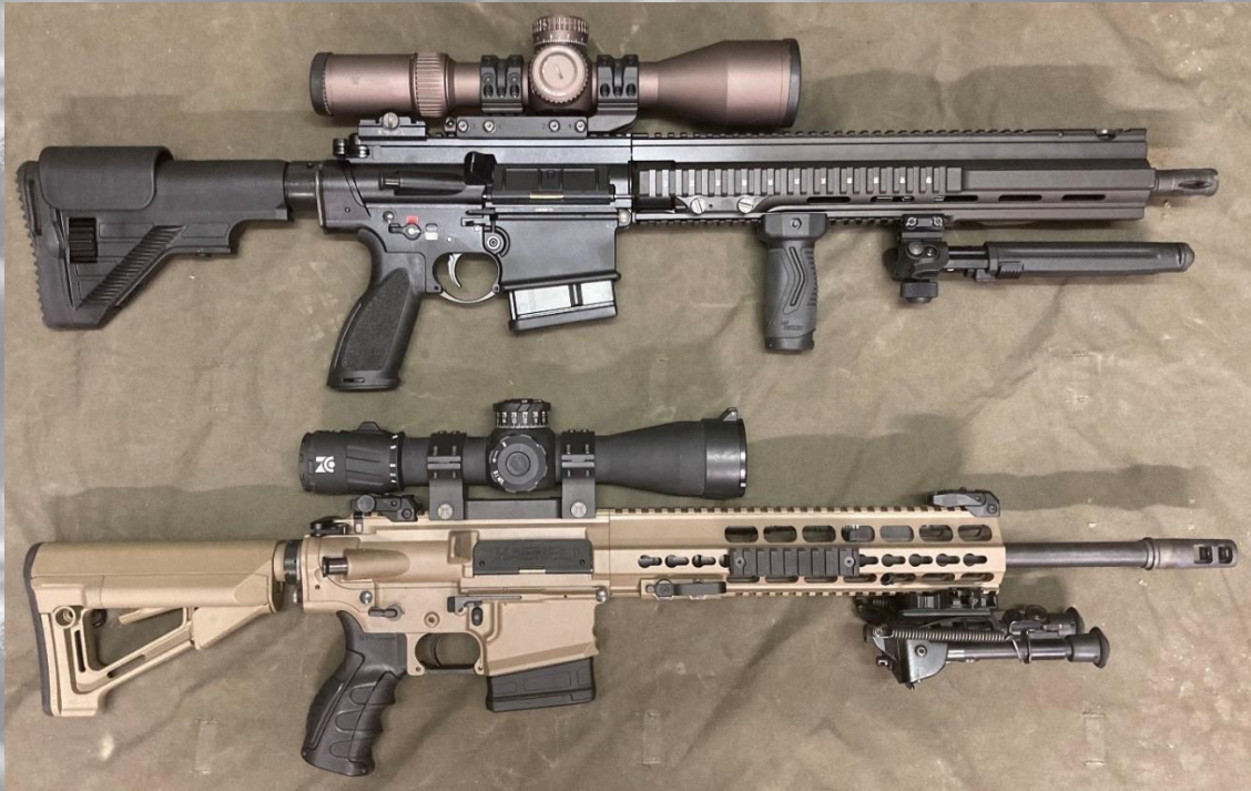
Oben H&K MR308 ohne Optik 5.15kg; unten Haenel CR308 ohne Optik 4.3kg
