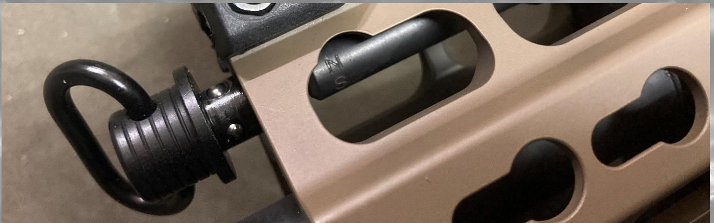
Universalwerkzeug, welches im Schaft auch als Riemenbügelöse fungiert.
