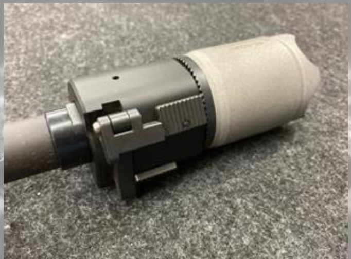
«A2» Feuerscheindämpfer mit B&T Rotex V Verschluss
