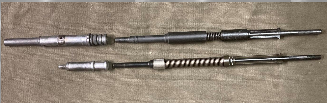
Oben Stangenstössel CR308 mit verstellbarer Gasabnahme; unten Stangenstössel CR223.
