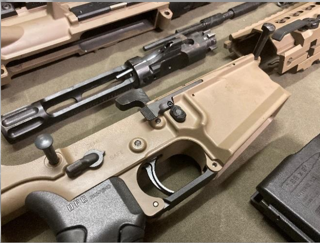
Haenel Lower mit Bolt-Release & -Catch
