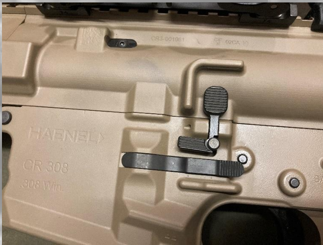
Verschlussfang- und Lösehebel CR308 links + Magazinknopf
