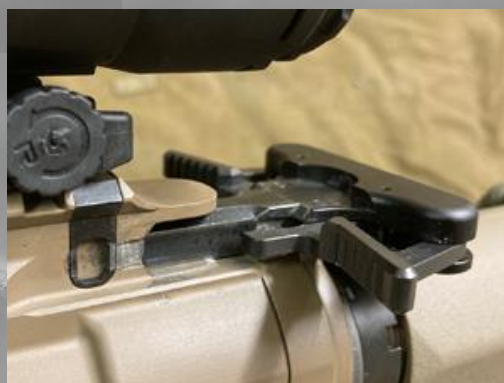
Verstärkung der Fangraste beim Ladehebel
