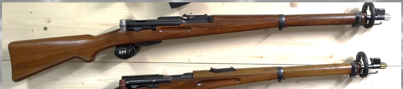
K31 im Originalzustand, bestes Erkennungsmerkmal der silberne Ladehebel. Unten K11 mit rotem Ladehebel.
